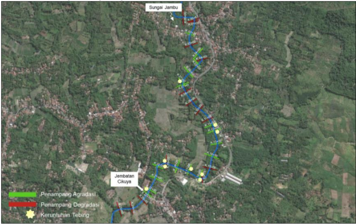
Gambar 9 Prediksi lokasi penampang melintang yang akan mengalami pengendapan, erosi, dan keruntuhan tebing dalam 10 tahun
