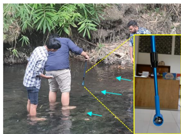
Gambar 6 Pengukuran kecepatan aliran dan alat ukur flow meter
