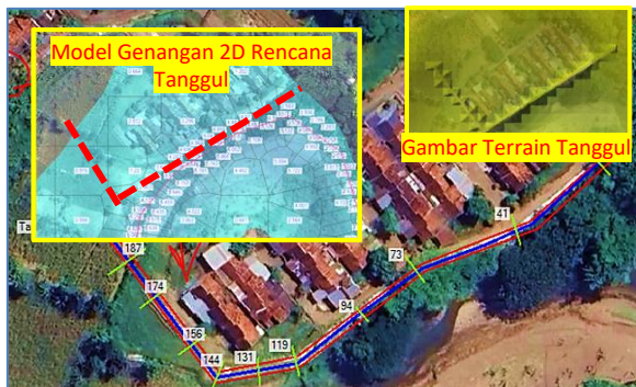
Gambar 13 Fitur Pembuatan Model Tanggul di 'Terrain' RAS Mapper
